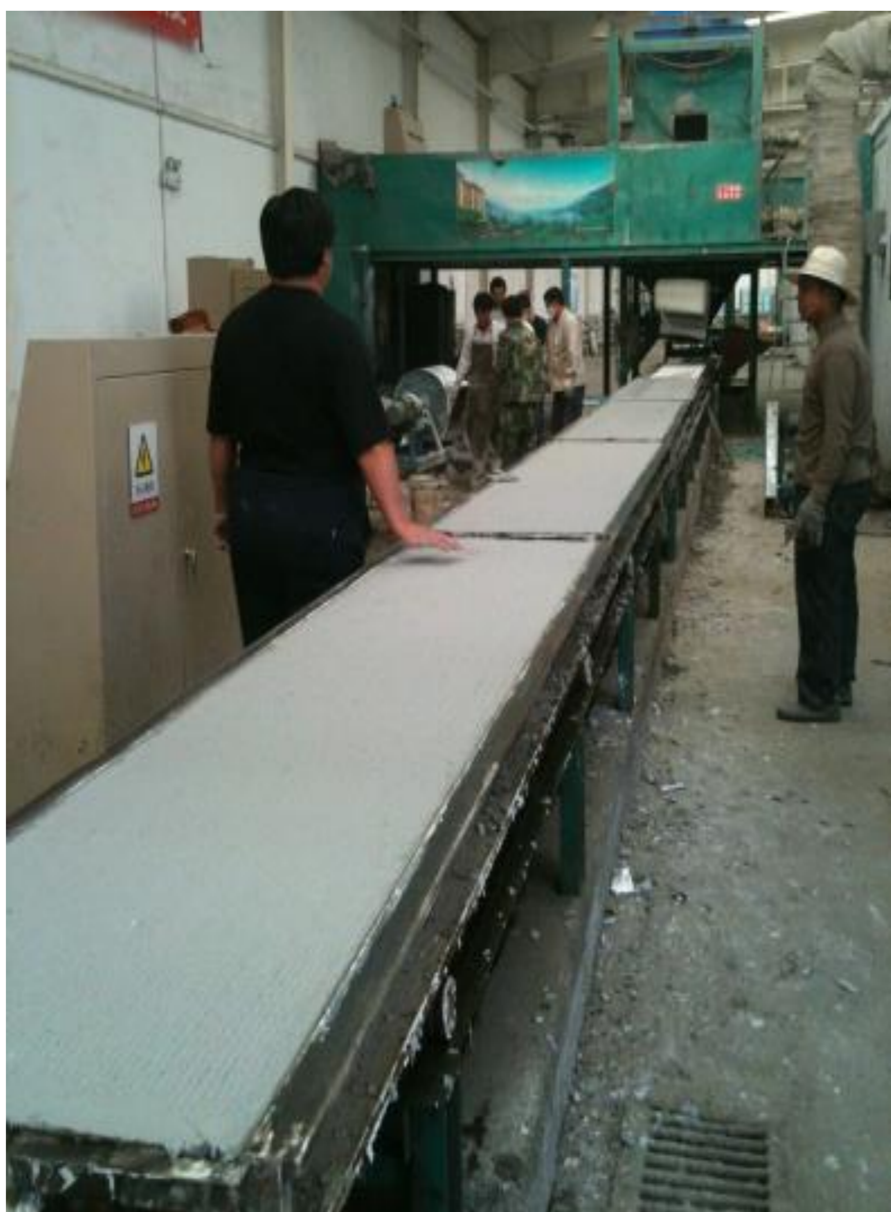
工厂试生产保温墙板
